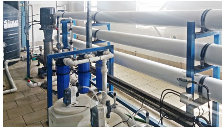
Figure 1 : Structure de l'étage de membrane avec la technologie ZLD en galvanoplastie plastique (gauche) Image de l'étage OI 1 (droite)
